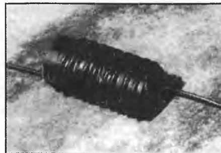
Příklad jednoduchého provedení cívky pro horizontální loop pro 40 m pásmo.
